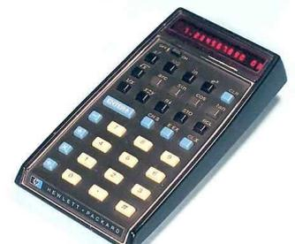
*Sortie de la HP-35, la première calculatrice scientifique, célèbre sous le nom de "règle à calcul électronique".*
